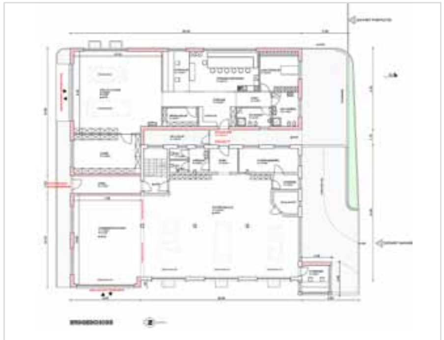
In rot gekennzeichnet die Erweiterung der Halle für die Feuerwehr, sowie der Zubau für die Bergrettung laut Vorprojekt (Skizze: Arch. Christian Oberhammer)
