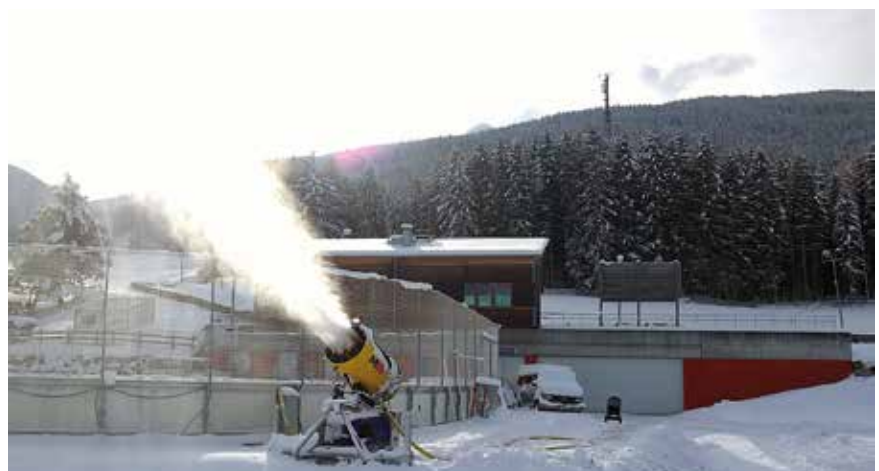
Die Produktion von Kunstsnow für Langlaufloipen, Eislaufplatz Zauberteppich und Rodelbahn benötigt neben Wasser einiges an elektrischer Energie.
